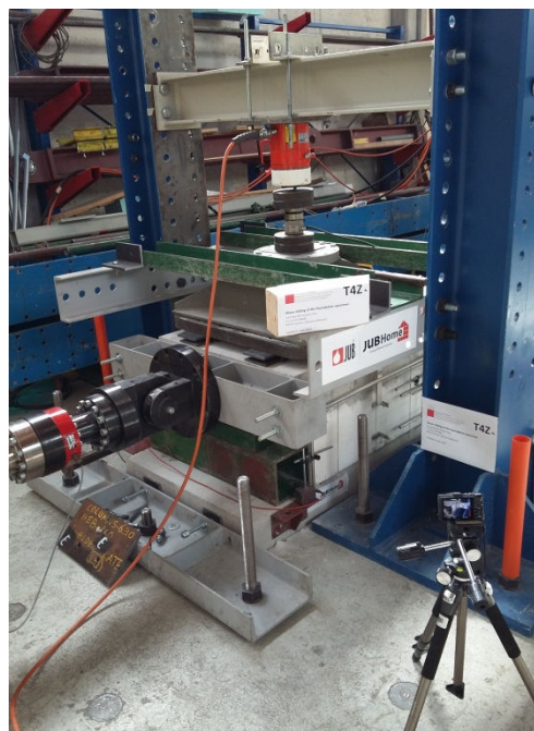
Slika 3.5: Preizkuševališče za monotone in ciklične strižne preizkuse temeljnega sklopa JUBHome BASE.
