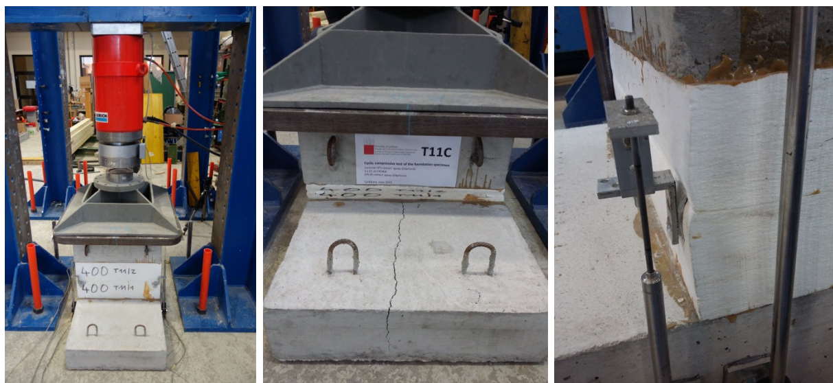
Slika 4.21: (a) Preizkuševališče za izvedbo cikličnega tlačnega preizkusa in preizkušanec T11C pred preiskavo, (b) preizkušanec T11C po preiskavi ( \varepsilon_{max} = 88 \% ) in (c) prikaz odlepljenja induktivnih merilnikov na vogalih zaradi prečnih deformacij plošč EPS400.
