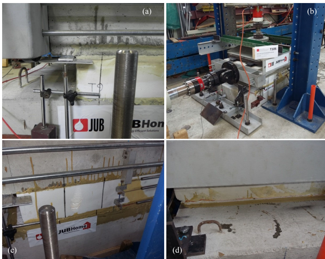
Slika 4.18: (a) Strižna deformacija v preizkušancu T9S, (b) preizkušanec T10S med preiskavo, (c) in (d) prestrig preizkušanca T10S po plošči EPS300, na podlagi česar je bila določena strižna trdnost materiala.
