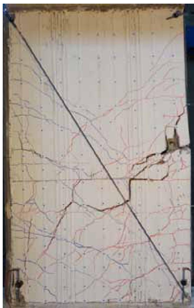
Slika 3 • Testiranje sten JUBHome WALL.
