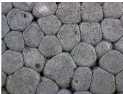
Slika 6: Struktura zrn EPSa večjih gostot
